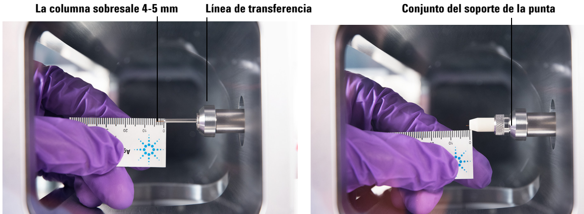
Figura 5 Instalación de una columna capilar en la interfaz GC/MS para una fuente EI HES
