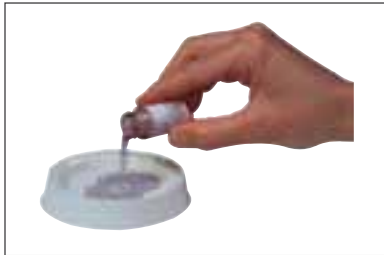
Mix sample/medium and pour onto SimPlate device. Distribute sample/medium and incubate.
